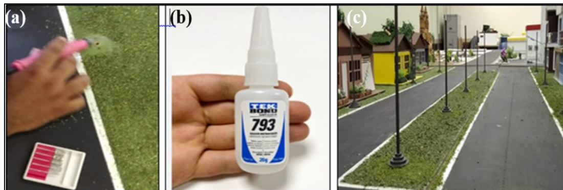
Figura 10 - (a) Localização, marcação e furação, (b) cola TEKBOND 793 de 20 ml, (c) bases prontas, canudos pintados, encaixados e já colados no layout do Projeto Cidade Inteligente.
