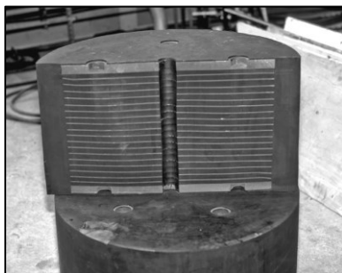
Figura 4 – Isolador Sísmico de Laminado de Borracha
