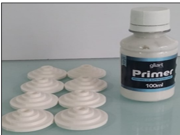
Figura 6- Primer Gliart e bases impressas em ABS branco
