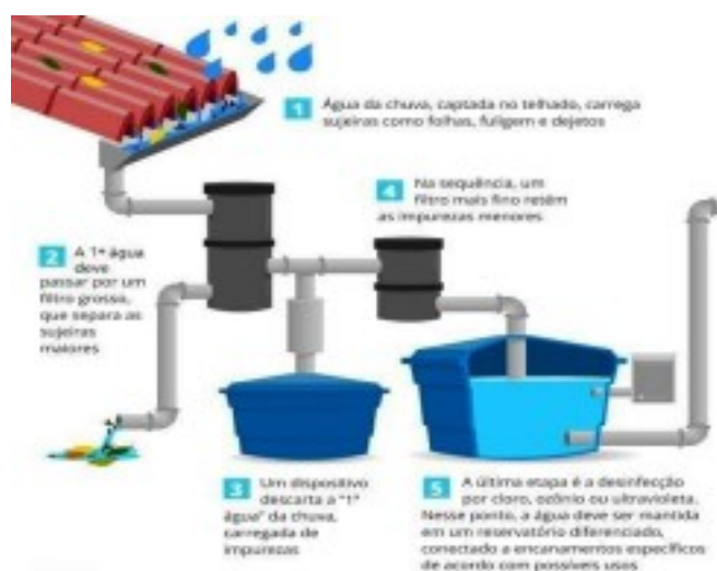
Figura 1- Captação e armazenamento da água da chuva
